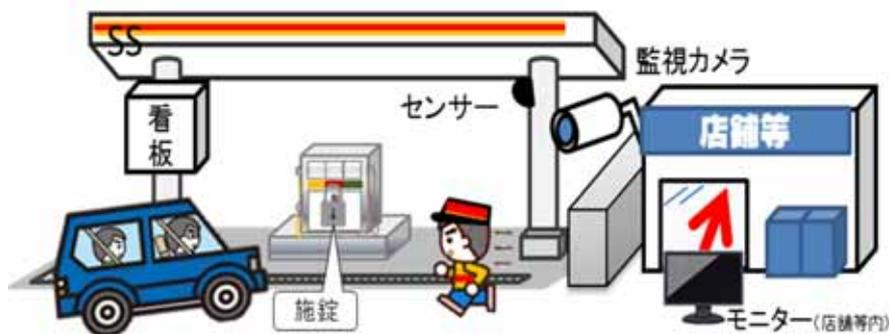
図1 呼び出しに応じて給油等を行う給油取扱所のイメージ
